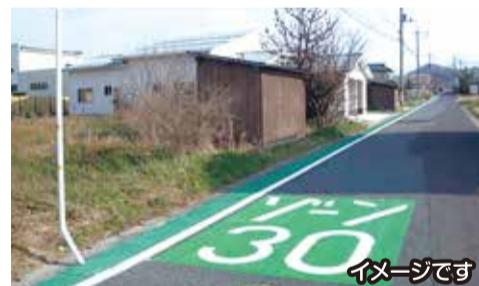
※ゾーン30とは…生活道路における歩行者や自転車の安全な通行を確保することを目的とした交通安全対策の一つで、区域(ゾーン)を定めて時速30キロの速度規制を実施するとともに、その他の安全対策を必要に応じて組み合わせ、ゾーン内におけるクルマの走行速度や通り抜けを抑制します。
